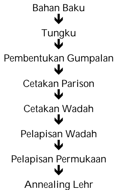
Gambar 3. 2. Skema Pembuatan Wadah Gelas
